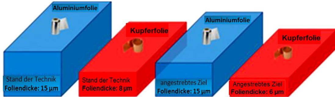
Ziel: ultrafeiner gewebebasierter Stromkollektor mit Foliendicke  $\leq 1 \mu\text{m}$
