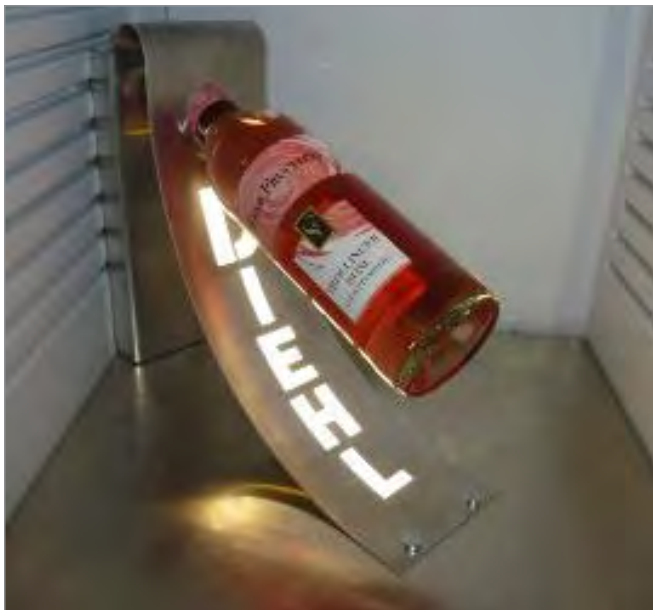
OLED-Demonstrator „Coolfood“ von DIEHL mit OLED-Modul, gefertigt auf ultradünnem flexiblen Glas von Fraunhofer FEP.
