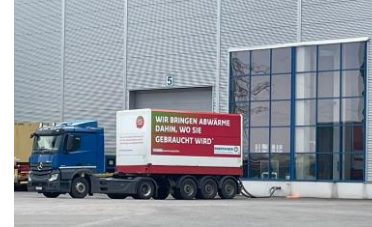
Abwärme aus Biogasanlagen für Industriehalle in MV
