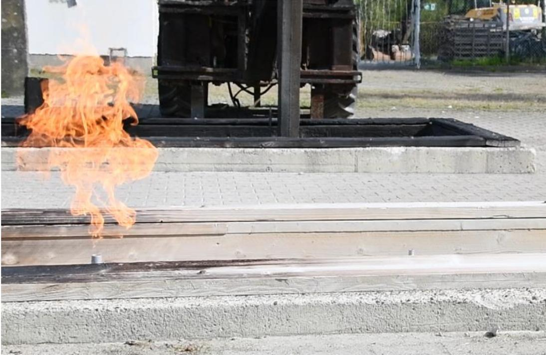
→ H<sub>2</sub> - Flamme bei Tageslicht nahezu unsichtbar; höhere Brenngeschwindigkeit
